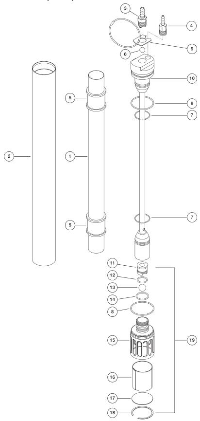
**MODEL .85 PORTABLE BLADDER PUMP CE - 81150115**
